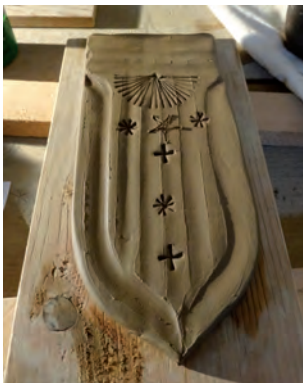
Ein vom Klosterziegler von Hand gefertigter Dachziegel
